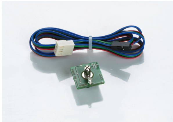
Ansicht Leiterplatte ca. 1:1 Sicht auf Sensor und LED-Funktionsanzeige
